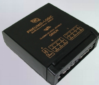
Ulazno izlazna jedinica ORION OZNAKA: 2006.49.00
